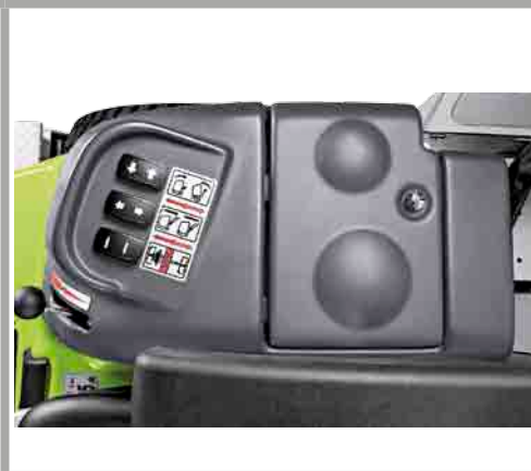
Блок управления с электрическими кнопками
